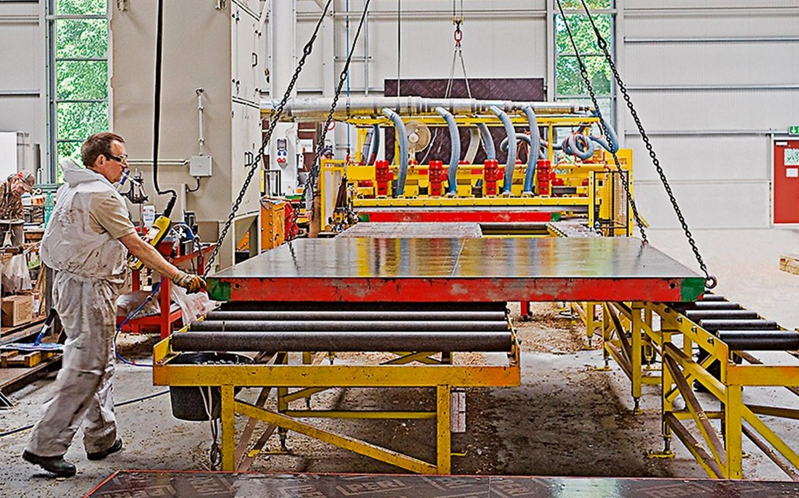
**Schalungssanierung** Schalungsreparatur Ersatzplatten
